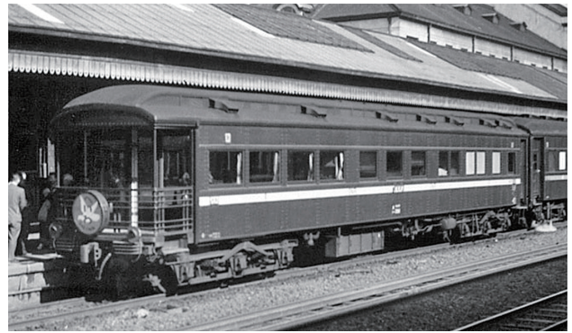
復活特急「へいわ」の一等展望車マイテ39型。三軸台車が特徴。©奥野利夫氏、撮影：京都駅1949年(HP:国鉄型車両ファイルより)。
