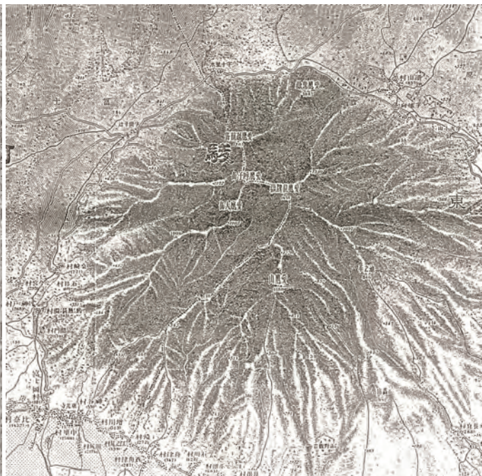
図3 十万分一帝国図 沼津(明治26年製版)、2万分の1地形図を10万分の1に編集・縮小された等高線を基準にケバ(暈滲)が描かれた。ドイツでは兵隊が等高線を読み取れないためケバに描き直したと言われていた(約66%縮小)。
