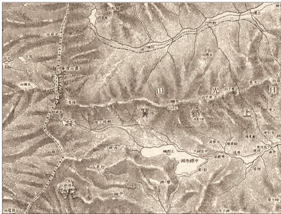
図1 輯製20万分の1図「日光」 明治20年製版 斜照のケバ（暈滂）、山の形は正式の測量に拠ったものではない。
