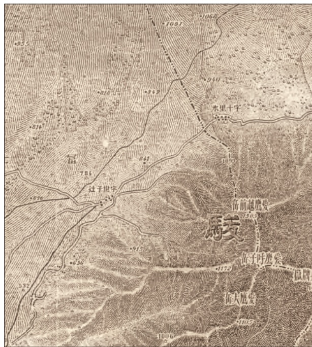
図4 10万分の1帝国図「沼津」明治26年製版 等高線を下敷きにして描かれたケバ図(直照暈渲)の例
